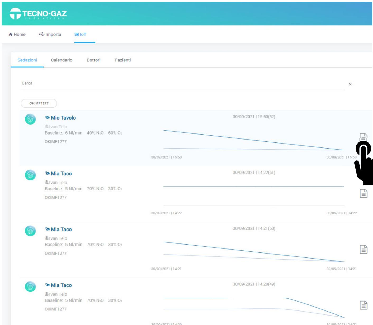
In ogni sedazione abbiamo il nome del paziente con sotto il nome del dottore, i valori di baseline e il codice di matricola del dispositivo che stiamo utilizzando.
